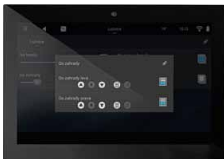
Žaluzie či rolety je možné spojovat do skupin a ovládat je hromadně.
