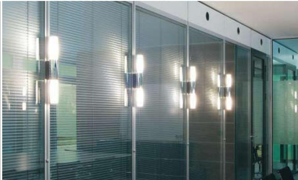
Wirtschaftliche Leuchten für Leuchtstofflampen in drei Materialausführungen. Zwei Leuchtgläser lassen sich unabhängig voneinander stufenlos drehen. Der Lichtaustrittswinkel der abgeblendeten Opalgläser beträgt immer 180° und kann um 360° in der Leuchtenachse verstellt werden. Einstellbares Licht für viele Bereiche, in denen die Lichtmenge den Erfordernissen der Situation angepaßt werden soll. Einfaches und werkzeugloses Öffnen der Leuchten (Deutsches Patent 44 20 045).
