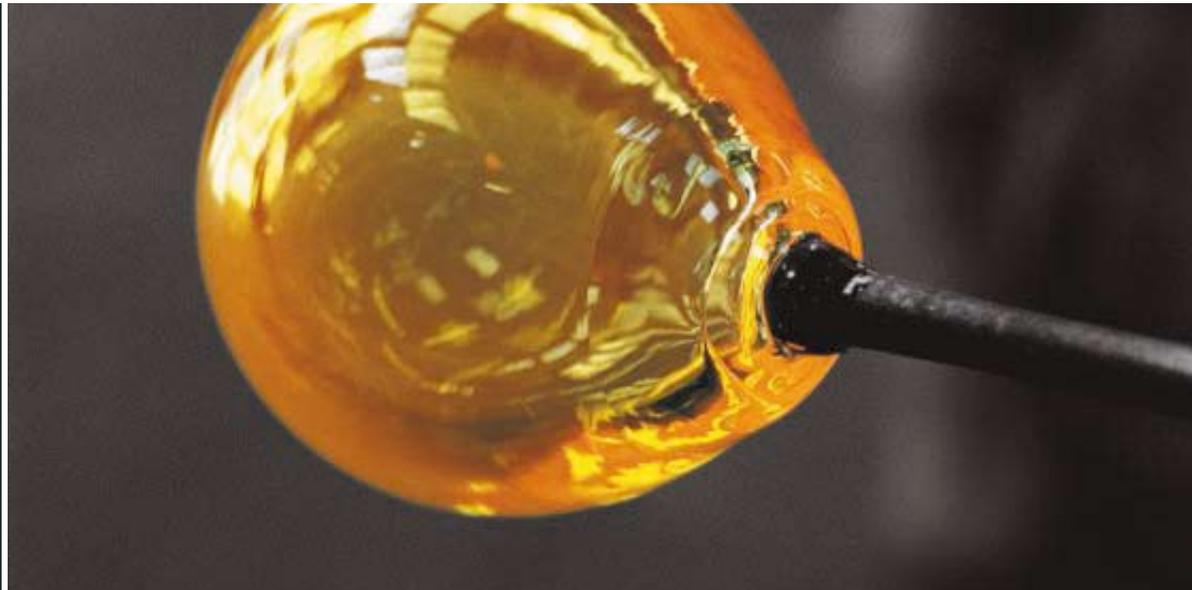
Während des Schmelzprozesses reagieren die Rohstoffe und zersetzen sich zur Glasschmelze, die sich nahezu vollkommen vermischt und entgast. Das Glas, so flüssig wie Honig, fließt geläutert durch einen Bodenkanal, den Durchlaß, aus der Schmelzwanne in die Arbeitswanne. Hier kühlt es auf etwa 1200 °C ab und wird zähflüssig. Jetzt können die Glasmacher ihre Arbeit beginnen.
