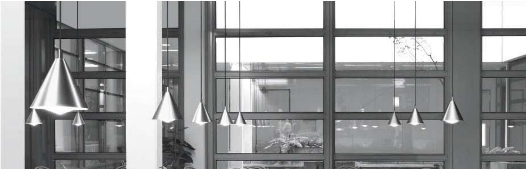
Geschlossene Pendelleuchten in unterschiedlichen Größen, Lichtleistungen und Materialausführungen für Halogenlampen und Leuchtstofflampen.
