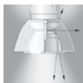
Zur Erzeugung einer hohen horizontalen Beleuchtungsstärke wird der größte Teil des Lichtes durch einen Reflektor nach unten gerichtet. Der verbleibende Teil sorgt als freistrahrender Lichtanteil für die vertikale Beleuchtungsstärke mit hohem Sehkomfort.
